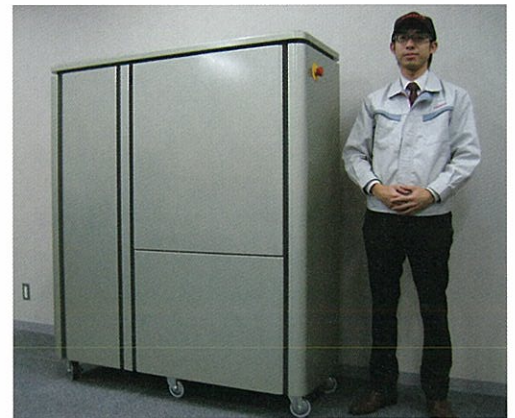
上：蓄電機能を備えた HEMS の概念図 右：リチウムイオン電池を使用した一次試作品 (資料提供：トヨタホーム)
