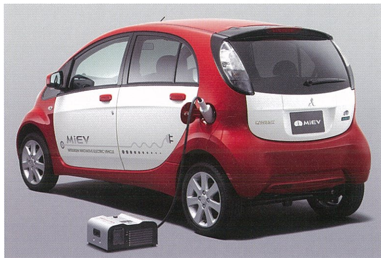
「MiEV power BOX」は最大出力1500W。一般家庭の約1日分の電力を取り出すことができる。
