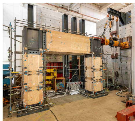
図 2.15 ラーメン架構の水平加力実験 (明治大学、2020) 10)
