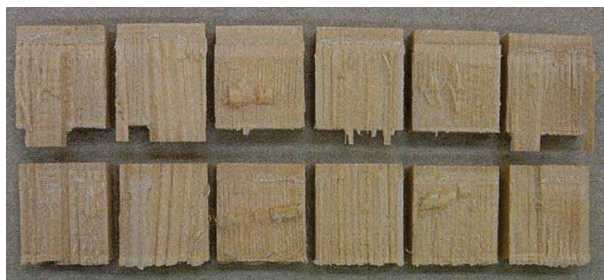
図 6.27 接着性能試験破壊性状（写真は上下一対で左から試験番号 1～6 の順番）
