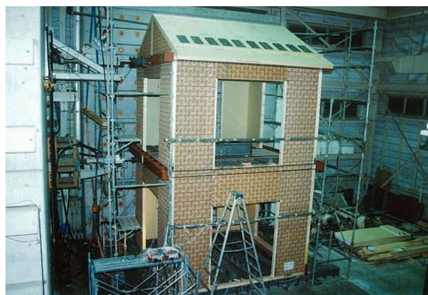
図 2.10 実大 2 層建築物水平加力実験 (工学院大学、1999) 6)
