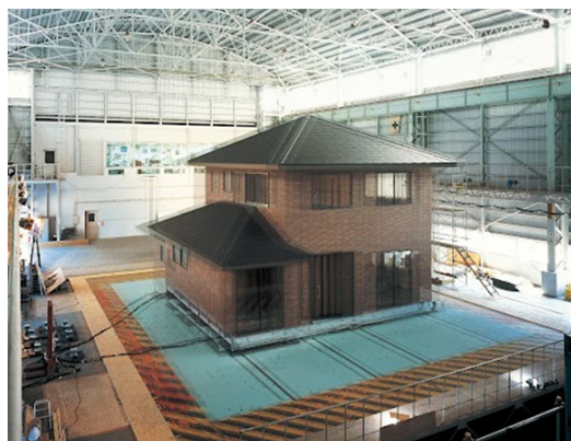
図 2.13 実大2階建て建築物振動実験 (防災科学技術研究所、2001) 9)
