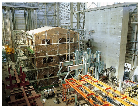
図 2.6 木質パネル構造3階建て実大水平加力実験（日本大学、1987） 2)
