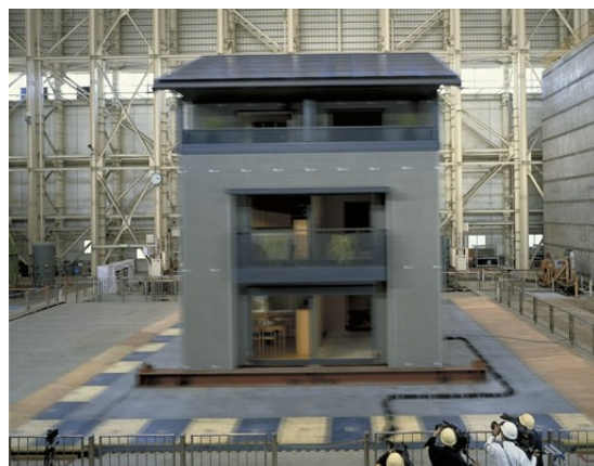
図 2.8 3 階建て実大振動実験 (原子力発電機構多度津工学試験所、 1997) 1)3)
